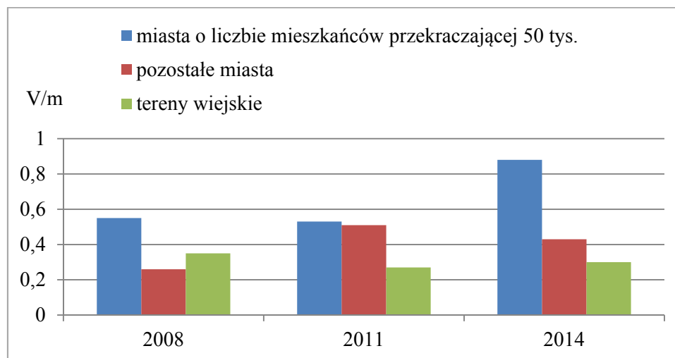
Wykres 5.3. Średnie poziomy natężenia PEM w woj. zachodniopomorskim w trzyletnim cyklu pomiarowym
