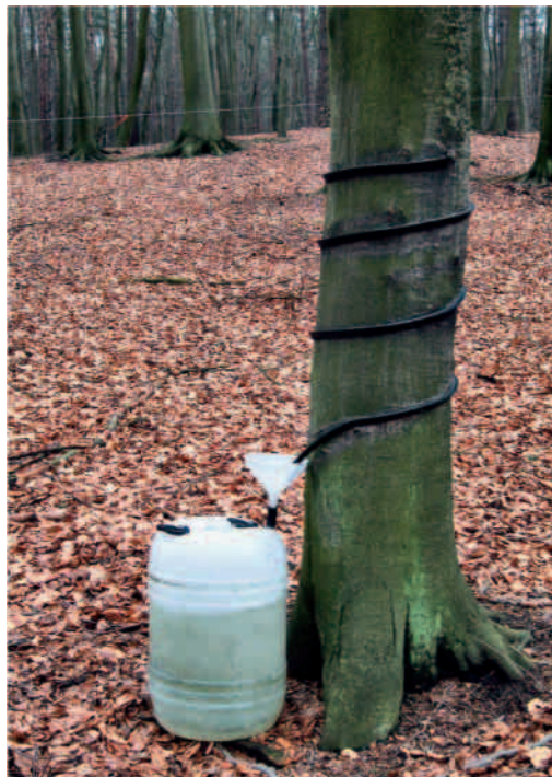
Fot. XIII.1. Stanowisko do poboru wód docierających do dna lasu w formie spływu po pniach drzew.
