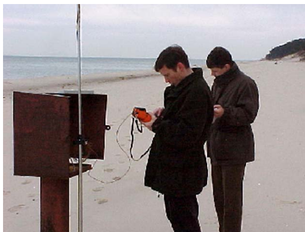
Skrzynka urządzenia pomiarowego – mareometru, pomiar w systemie GPS (lokalizowanie urządzenia)
